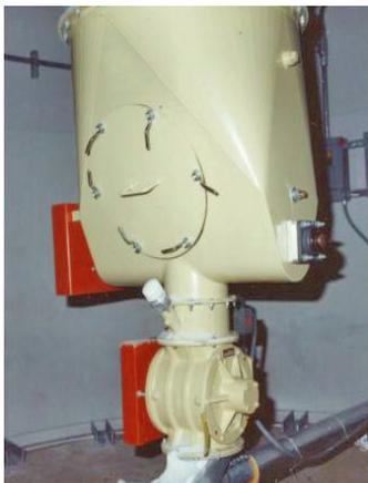
料仓卸料器可以将排出的物料搅拌均匀，然后将其送入旋转阀。
